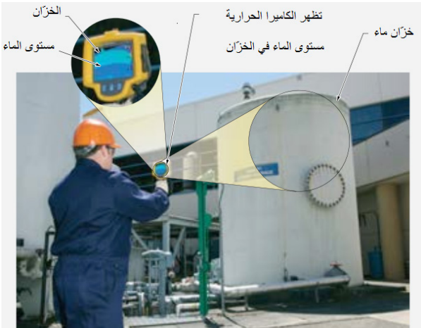
الشكل 4. الكشف عن مستوى السائل في خزّان مغلق باستخدام التصوير الحراري.
