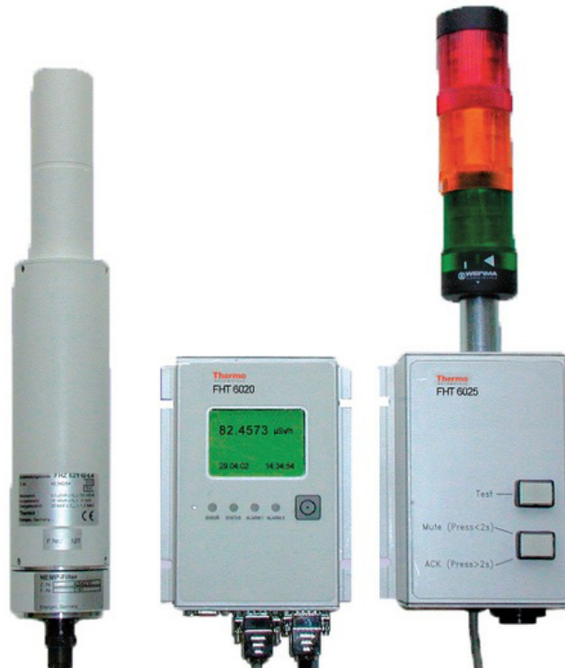
الشكل 2. منظومة مراقبة إشعاعية تستعمل في محطات الإنذار المبكر.
